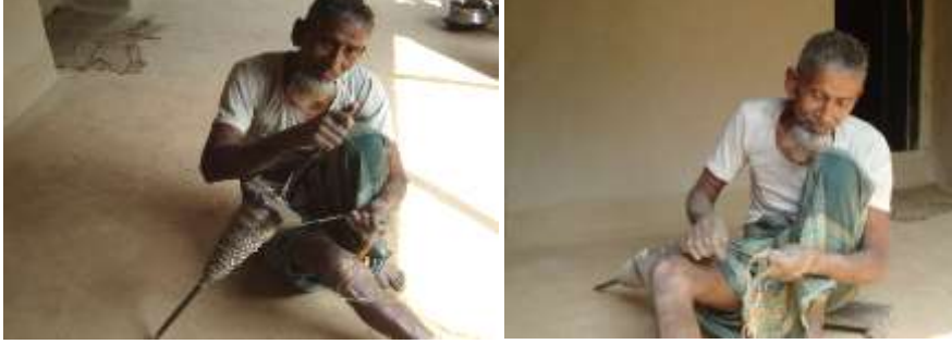
চিত্র ৬: ডান হাত ও উরুতে টাকুর ঘুরিয়ে পাটের লোয়া তৈরি, ২০১২ খ্রি., মালাহার, ধামইরহাট, নওগাঁ (ছবি: লেখক)
