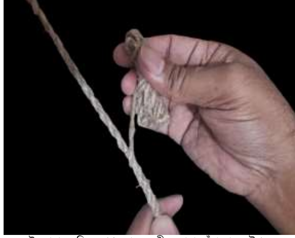
চিত্র ১১: দুই লোয়ার দড়িতে পৃথকভাবে তৃতীয় লোয়া পেঁচানোর কৌশল, ২০২৫ খ্রি., মিরপুর, ঢাকা (ছবি: মম পূর্ণতা)
