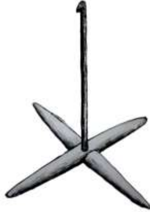
চিত্র ৮: দড়ি তৈরির যন্ত্র ট্যাড়া, ২০১৪ খ্রি., শাহ কৃষি তথ্য কেন্দ্র ও জাদুঘর, নওগাঁ'র সংগৃহীত ট্যাড়ার আলোকচিত্র থেকে ড্রইং (ছবি ও ড্রইং: লেখক)
