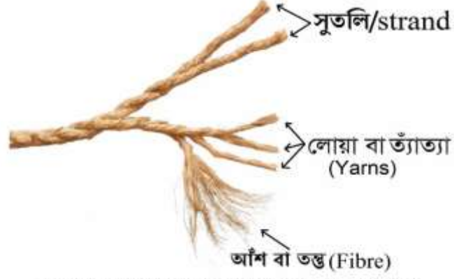
চিত্র ১: তিন সুতলি বিশিষ্ট দড়ি (প্রতিটি সুতলি চারটি লোয়া সমন্বয়ে তৈরি)
