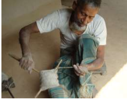
চিত্র ৪: ডান হাতে বেলনি ঘুরিয়ে পাটের লোয়া তৈরি, ২০১২ খ্রি., মালাহার, ধামইরহাট, নওগাঁ (ছবি: লেখক)
